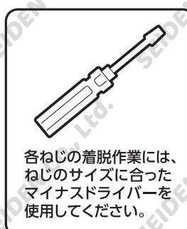
各ねじの着脱作業には、ねじのサイズに合ったマイナスドライバーを使用してください。
