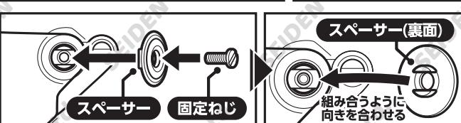
2 スペーサーをシールドベースにセットします。このときスペーサーの裏面とシールドベースの形状を合わせます。次にねじで固定して完了です。
